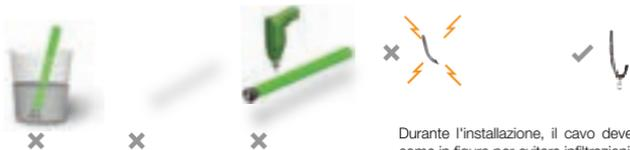
Durante l'installazione, il cavo deve essere posizionato come in figura per evitare infiltrazioni d'acqua
