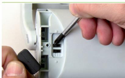
Corsa facilmente regolabile fino a 9 posizioni tramite dip-switch, anche a motore non alimentato.
