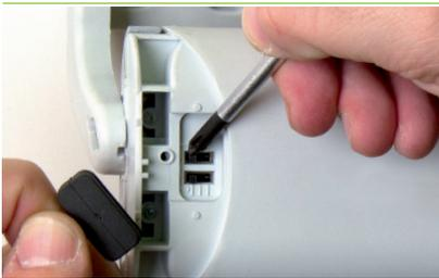
Carrera fácil de regular hasta 9 posiciones mediante dip-switch, incluso con el motor sin alimentación.
