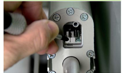
Réglage aisé de la course (jusqu'à 10 positions) via dip-switch, y compris si le moteur n'est pas alimenté. Réglage millimétrique sur le modèle Regulator.
