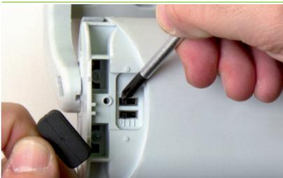
Réglage aisé de la course (jusqu'à 9 positions) via dip-switch, y compris si le moteur n'est pas alimenté.
