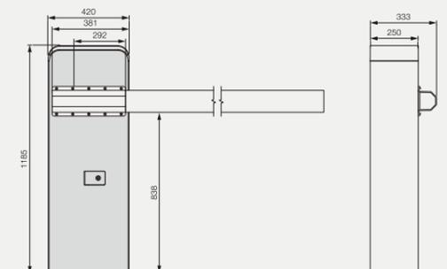
Para hastes até 7 m de comprimento (3+4 m) e até 8 m (4+4 m)
