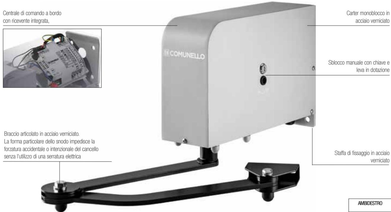
Condor 500 S è un attuatore a braccio articolato ambidestro resistente, compatto e fornito di centrale di comando a bordo. Adatto al montaggio su pilastri stretti a partire da 120 mm, garantisce massima sicurezza nelle manovre di soccorso e massima
