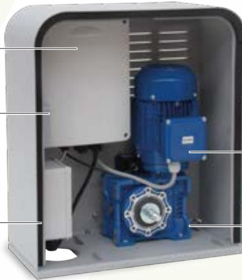
Motorreductor con ventilación integrada, disponible en versiones 230V trifásico ~ y 380 VAC
